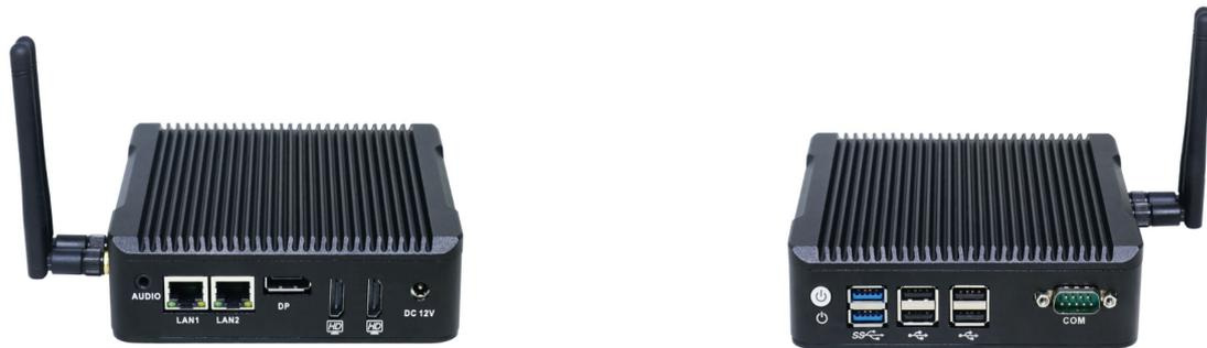
PC industriale di colore nero interamente realizzato in alluminio di spessore generoso per garantire una robustezza e una dissipazione adatta per ogni tipo di ambiente. Il sistema è totalmente Fanless. L'elettronica di questo modello è interamente allo stato solido.
